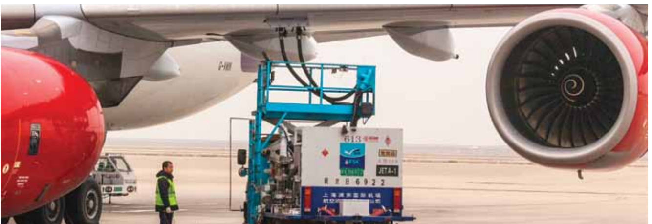
Into-plane refuelling operations at Shanghai Pudong International Airport 在上海浦东国际机场为飞机加注
