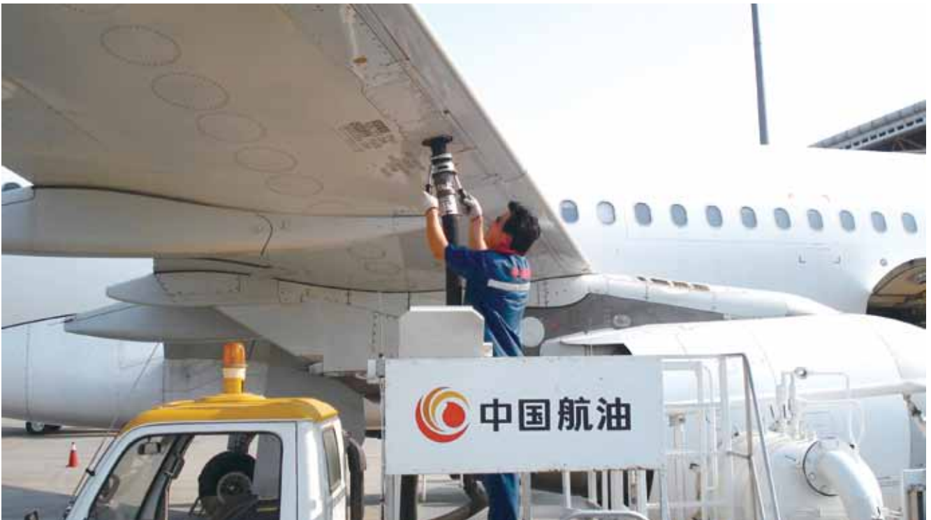
Into-plane refuelling operations 在机场的航油加注服务
